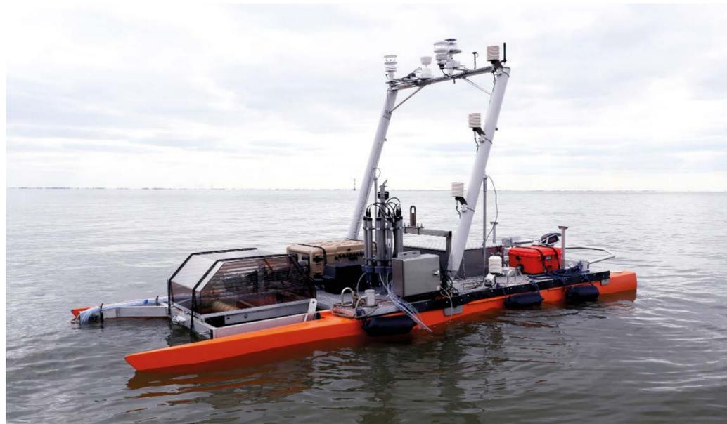
Der neue, autonome Forschungskatamaran des ICBM bei einer Probefahrt im Jadebusen im April. Die Messplattform kann unter anderem Proben von der Oberflächen-Mikroschicht und aus verschiedenen Wassertiefen nehmen.
