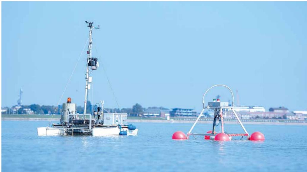
Der ferngesteuerte Katamaran S<sup>2</sup> (im Bild links mit einer Messboje) war bislang die wichtigste Messplattform der ICBM-Arbeitsgruppe „Prozesse und Sensorik mariner Grenzflächen“. Im Projekt NorthSat-X entwickelt das Team nun eine autonome Version weiter. Der neue Katamaran kann Messpunkte auf einer geraden Linie abfahren und soll Referenzdaten für Satellitenmessungen liefern.
