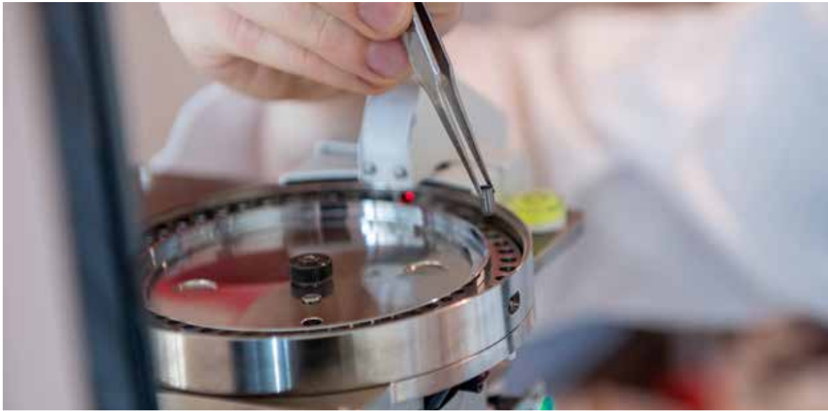
Kompakt in einem kleinen Tiegel – so landet die fertig präparierte Probe auf dem Probensteller, bevor sie bei 590°C in der Pyrolyse zersetzt wird. Anschließend bestimmt ein Messgerät den Gehalt der verschiedenen Kunststoffe. Foto: Daniel Schmidt
