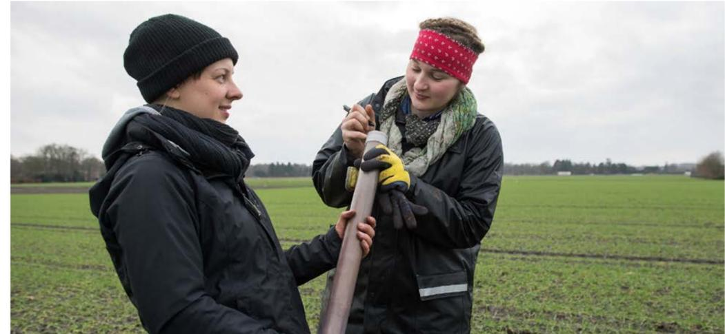
Bei Wind und Wetter im Einsatz: Rieke Wahlen (re.) entnimmt auf dem Feld eine Bodensäule für Laborversuche.
