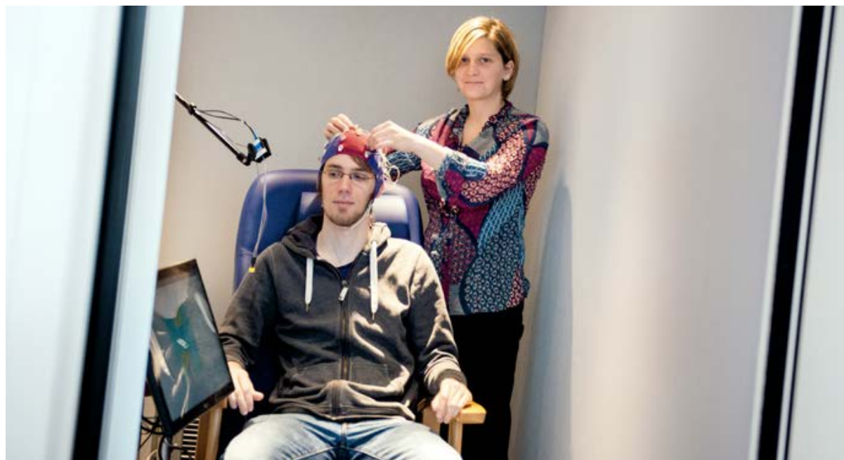
Mithilfe von Elektroden misst Sarah Verhulst bei Testpersonen die sogenannten Hirnstammpotenziale. Dies soll in Kombination mit weiteren Methoden auch bislang unerkannte Hörschäden diagnostizieren helfen. Foto: Daniel Schmidt
