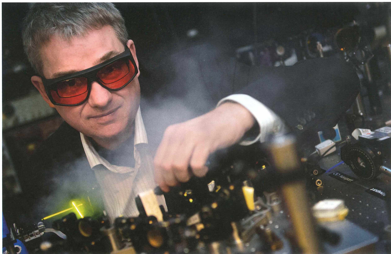
Christoph Lienau justiert einen Femtosekundenlaser, der ultrakurze Elektronenimpulse erzeugt.
