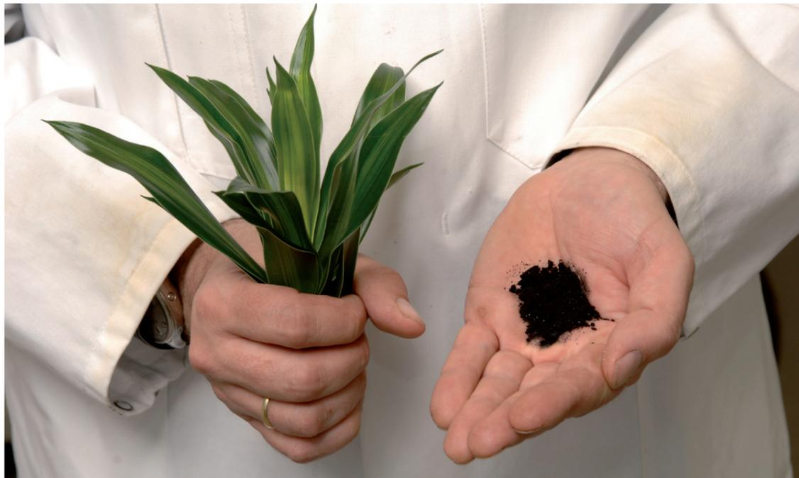
Aus Biomasse entsteht Kohle, die vielfach verwendet werden kann – zum Beispiel als Elektrode für Batterien. Foto: Norbert Michalke
