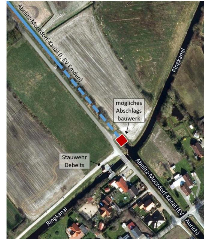
Abb. 45: Möglichkeit zur Schaffung eines Abschlagsbauwerks am Ringkanal oberhalb des Stauwehres Debelts (Orthophoto: LGLN)
