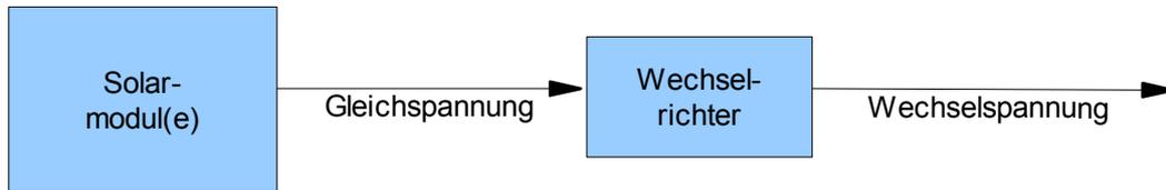
Die Photovoltaik-Anlage erzeugt eine Gleichspannung. Diese ist unter anderem abhängig von der Intensität der Lichteinstrahlung. Der Wechselrichter transformiert die Gleichspannung in eine stromnetzkonforme Wechselspannung mit einem Effektivwert von ca. 230 Volt.
