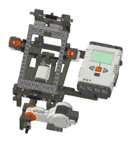
Die Anschlusskabel für die Lichtsensoren müssen durch den Bügel am oberen Rand des beweglichen Rahmens geführt werden, da ansonsten die freie Drehbarkeit des Rahmens durch die steifen Kabel beeinträchtigt wird.
