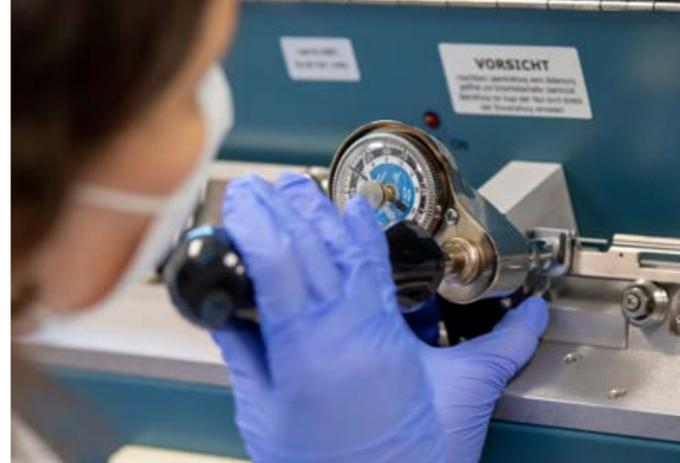
Die winzigen Druckdüsen aus Spezialglas präpariert Liaisan Khasanova mit einem sogenannten Mikropipettenzuggerät.
