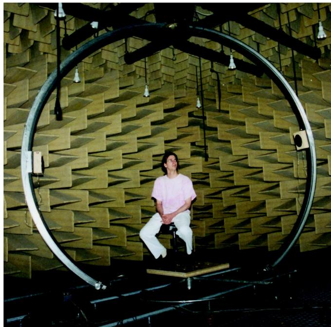
Die Eigenschaften des Richtungshörens und binauralen Hörens lassen sich mit einer speziell konstruierten Apparatur im reflexionsarmen Raum der Universität ausmessen, in dem zwei Lautsprecher Schrittmotor-gesteuert an beliebige Orte einer Kugeloberfläche gefahren werden. Anwendungen sind das Vermessen der Ortungsgenauigkeit einzelner Versuchspersonen und die Erstellung einer "virtuellen akustischen Realität" mit dem Computer unter Verwendung der ausgemessenen Ohr-Übertragungseigenschaften.
