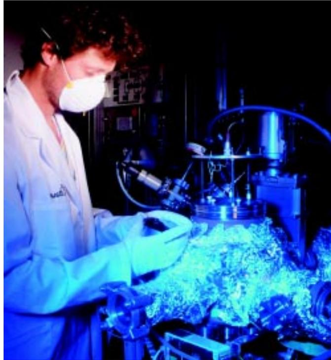
Hochvakuumanlage zur Herstellung von amorphen Silizium-Dünnschicht-Halbleitern. Die Schichten werden bei niedrigerer Temperatur ( $T \ll 200^\circ\text{C}$ ) aus der Gasphase (z.B. Silan) durch eine Glimmentladung direkt auf einem Glassubstrat abgeschieden. Indem mehrere verschiedene Schichten übereinander aufgebracht werden, lassen sich komplette Solarzellen herstellen.
