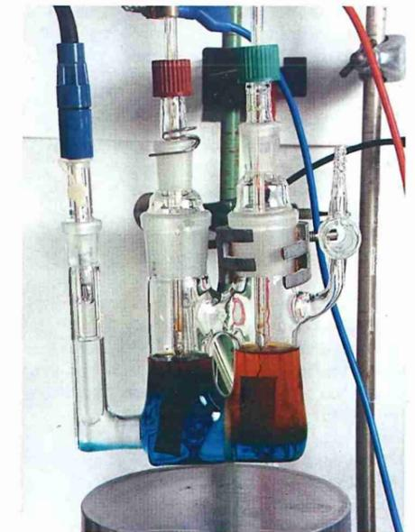
Abb. 1: Elektrolysezelle für Laboruntersuchungen. Blau: Kathodenraum, Rot: Anodenraum. Im mit farbloser Lösung gefüllten Raum befindet sich eine weitere Elektrode, welche der Kontrolle der Elektrolysespannung dient.
