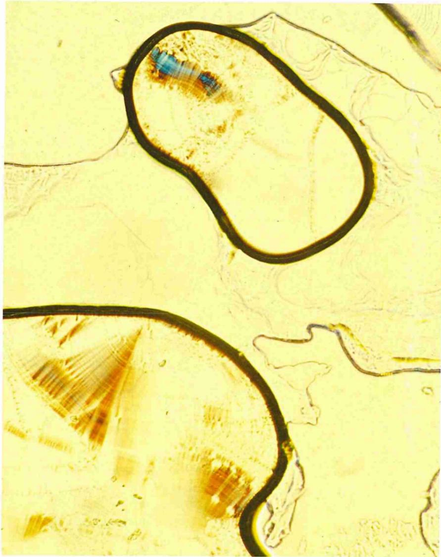
Gleiche Kristalle vom Typ 2 nach Erhitzen über den Schmelzpunkt von 132°C. Betrachtung in polarisiertem Licht bei parallelen Nicols.
