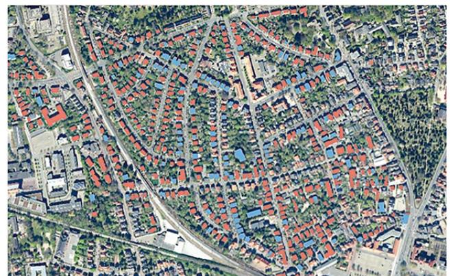
Die Abbildung zeigt das Ergebnis einer KI-basierten Klassifikation von Potenzialgebäuden für Kleinwindenergieanlagen. Blau eingefärbte Gebäude eignen sich, rot eingefärbte eignen sich nicht für die Errichtung der Anlagen. (Quelle: <https://www.vde-verlag.de/buecher/537717/kuenstliche-intelligenz-in-geodaesie-und-geoinformatik.html>)
