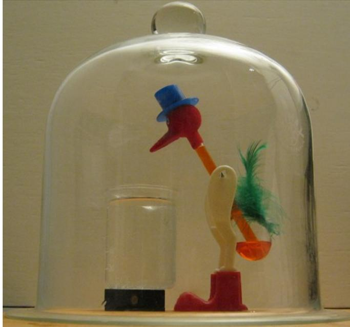
Abb. 4: Wird der Stofftransport behindert, hört die Ente auf zu trinken.
