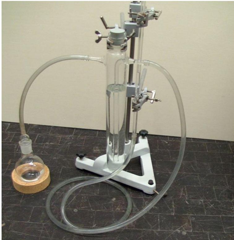
Abb. 4: Dampfdruck von Alkohol hebt eine Wassersäule.
