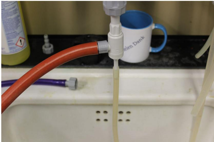
Abb. 5: Wasserstrahlpumpe
