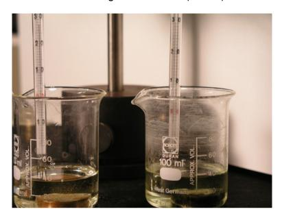
Abb. 2: Kupfer und Eisen nehmen bei gleicher Masse unterschiedlich viel Wärme auf.
