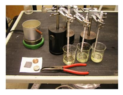
Abb. 1: Versuchsaufbau mit Kocher und 3 Bechergläser mit Salatöl.
