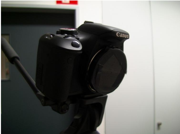
Abb. 1: Spiegelreflexkamera mit Loch als Linse
