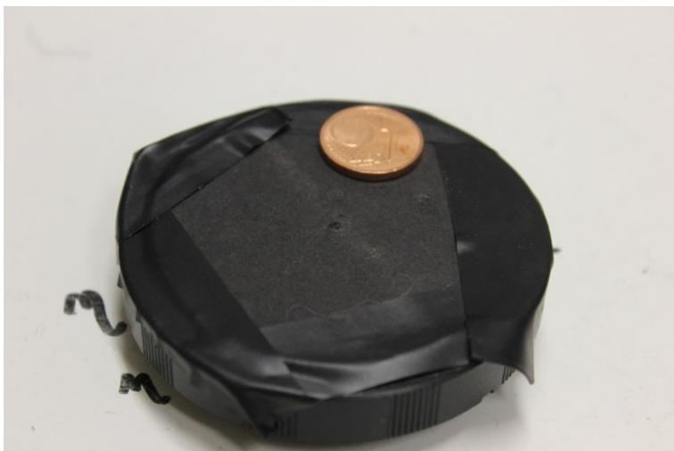
Abb. 2: Kameraadapter mit Karton und kleinem Loch.
