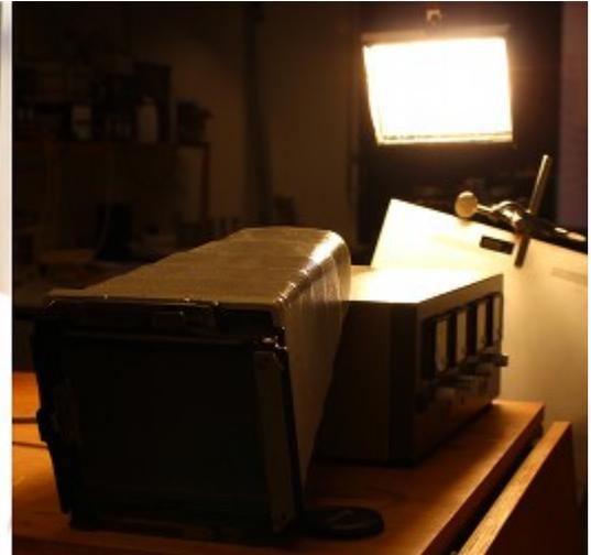
Abb. 4: Mattscheibe durch ein Loch mit dem Halogenstrahler beleuchtet.
