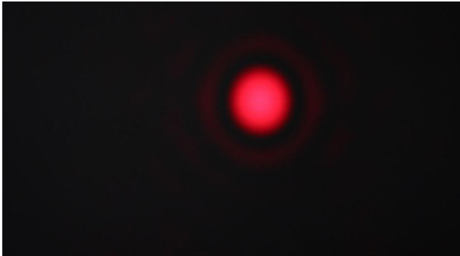
Abb. 8: Fotografie der Fraunhoferbeugung einer Öffnung mit  $20\ \mu\text{m}$  Durchmesser.
