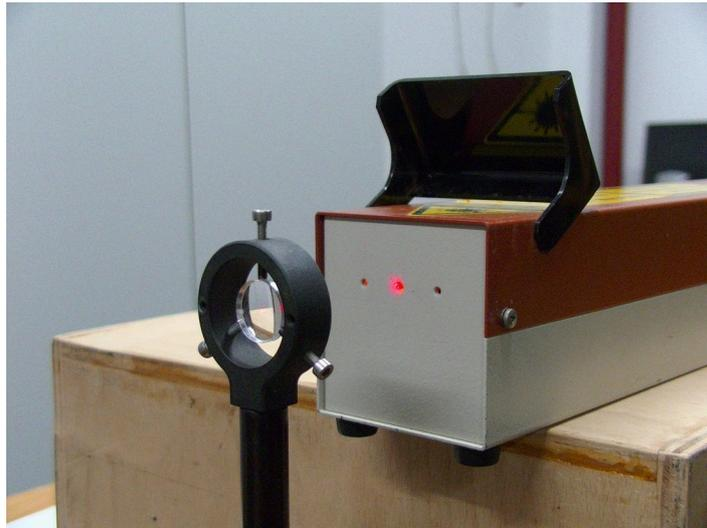
Abb. 1: Laser mit einfacher Aufweitung.
