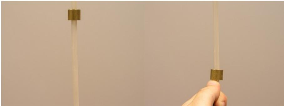
Abb. 3: Das Ziehen des Schlauchs bewirkt eine Querkontraktion
