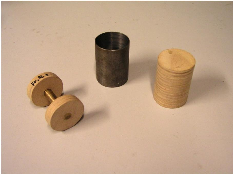
Abb. 2: Rollkörper mit unterschiedlicher Massenverteilung
