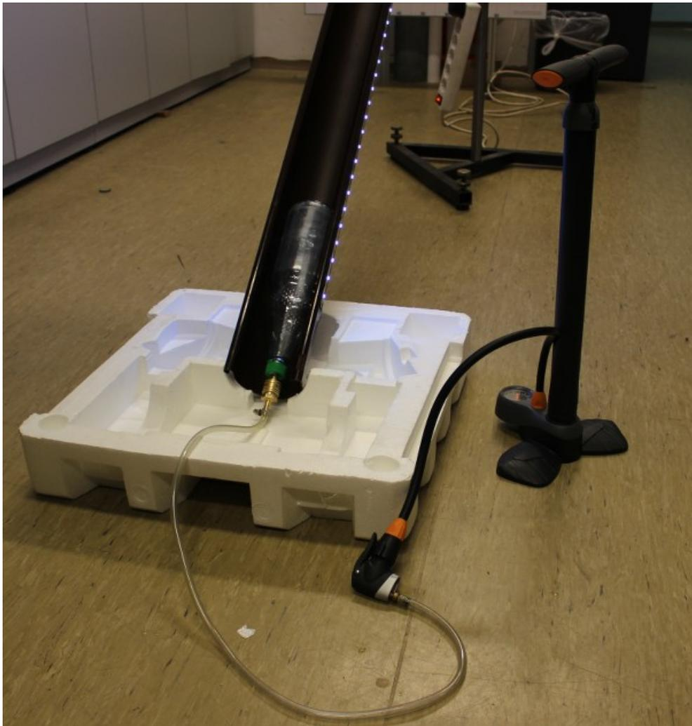
Abb. 2: Versuchsaufbau zum Raketenantrieb
