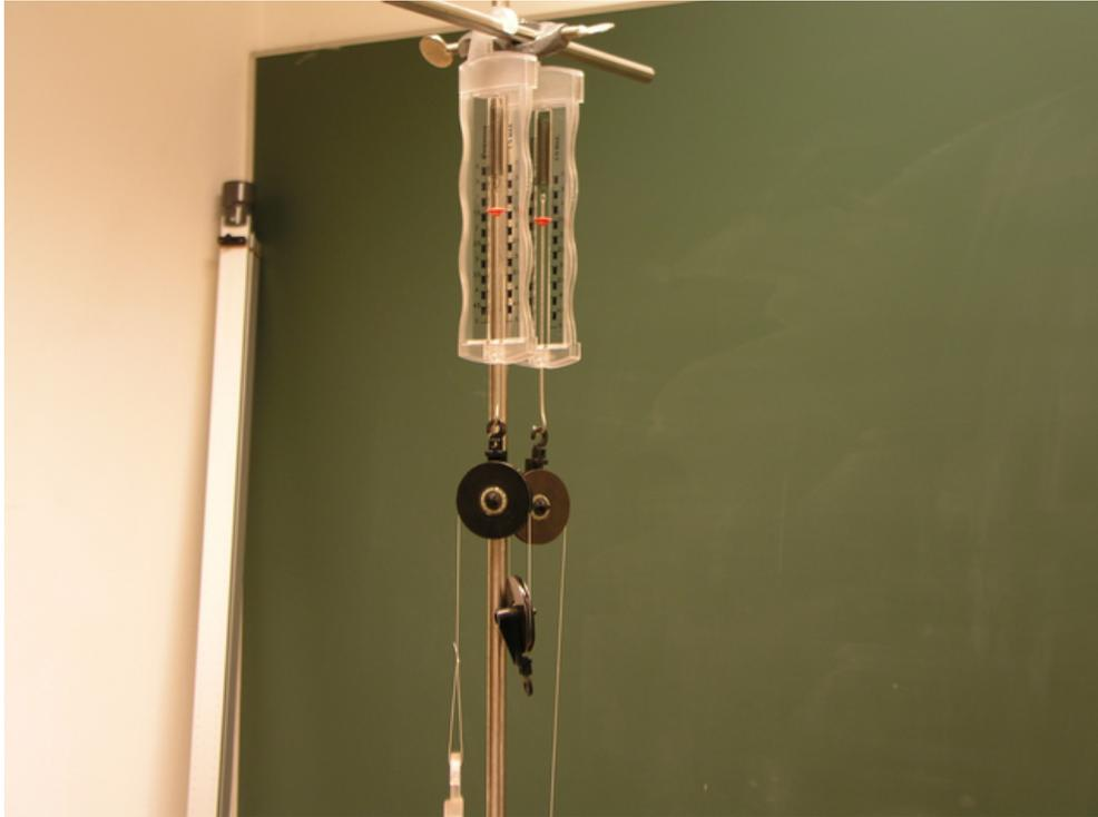
Abb. 6: Unbelasteter Flaschenzug
