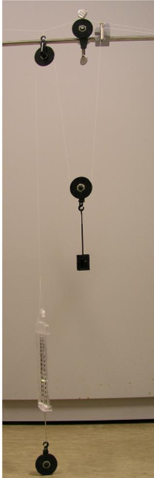
Abb. 4: Das Heben der  $100\text{ g}$  Masse benötigt bei Verwendung eines Flaschenzuges aus 2 Umlenkrollen weniger Kraft ( $\approx 0,6\text{ N}$ ) trotz der relativ hohen Masse der Rolle von ca.  $70\text{ g}$ , die in diesem Fall mit angehoben werden muss.
