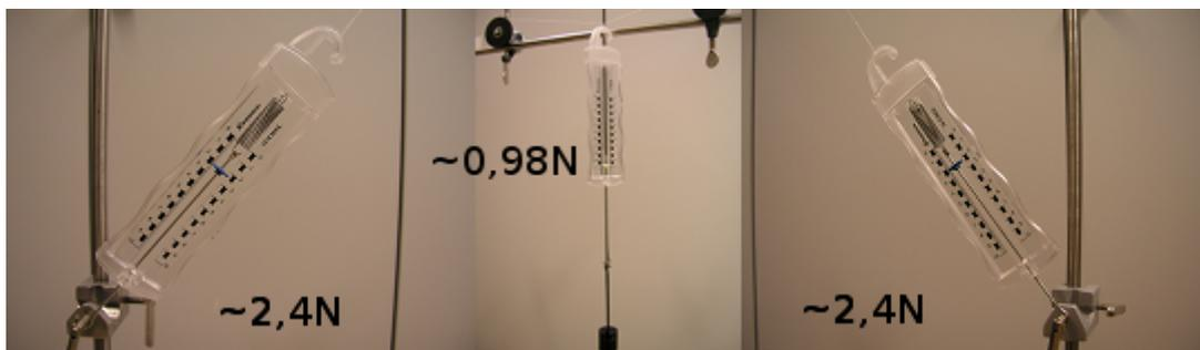
Abb. 2: Kräfte zum Heben einer Masse von  $100\text{g}$ . Die Messbereiche der Äußeren beiden Kraftmesser betragen jeweils  $10\text{N}$  und der des mittleren  $1\text{N}$ .
