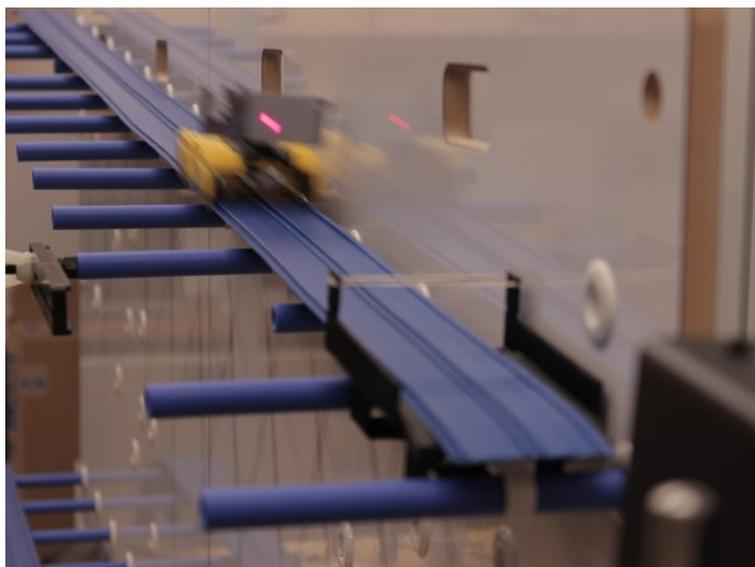
Abb. 3: Ein Rollwagen auf einer schiefen Ebene, seine ortsänderung wird mit einem Laser Distanz Sensor beobachtet.
