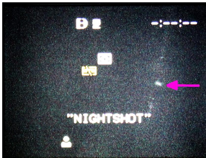
Abb. 3: IR-Leuchten einer Diode
