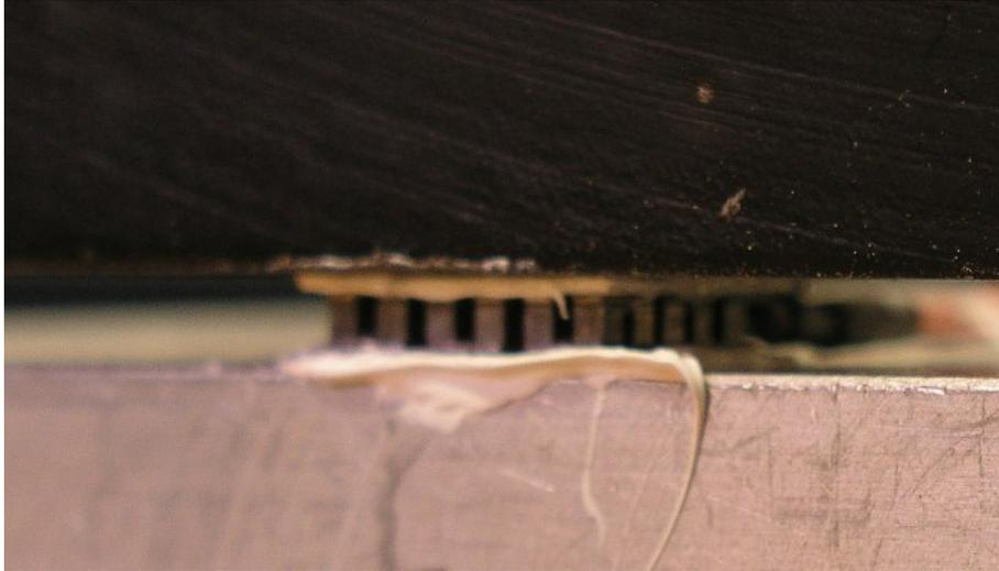
Abb.1: Peltierelement zwischen 2 Aluminiumblöcken
