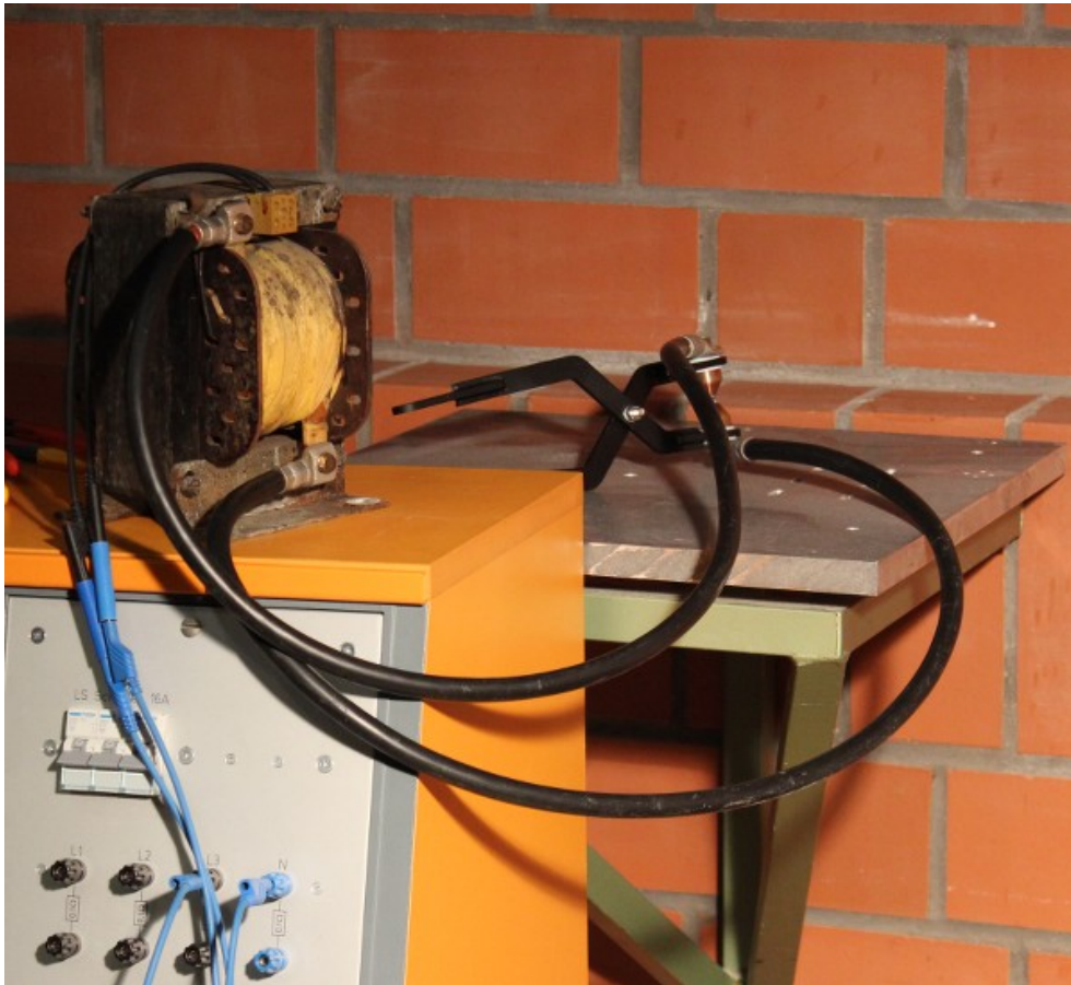
Abb. 6: Mit dieser Vorrichtung können dünne Bleche verschweißt werden, nicht zu fest drücken, sonst ist der Übergangswiderstand zu klein und die Leitungen werden heiß.
