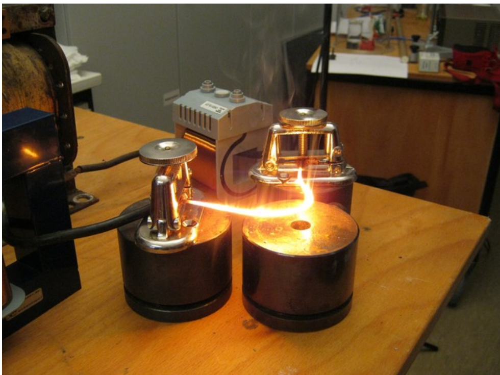
Abb. 4: Primärseitig fließen hier keine 2 A (Messgerät links oben, Skala um Faktor 10 zu groß) bei 147 V (Hintergrund). Rechts im Vordergrund ist ein Messtransformator angekoppelt der den Sekundärstrom um Faktor 1200 zu klein anzeigt \rightarrow \approx 50 \text{ mA} \cdot 1200 = 60 \text{ A} .
