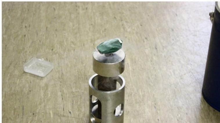
Abb. 3: Supraleiter in aufgeschnittenem Ballon mit Watte als Speicher für flüssigen Stickstoff.
