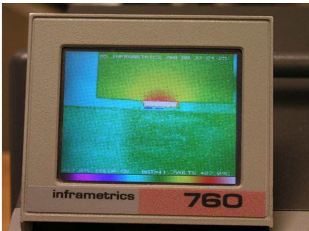
Abb. 4: Infrarotbild eines Peltierelementes in Betrieb
