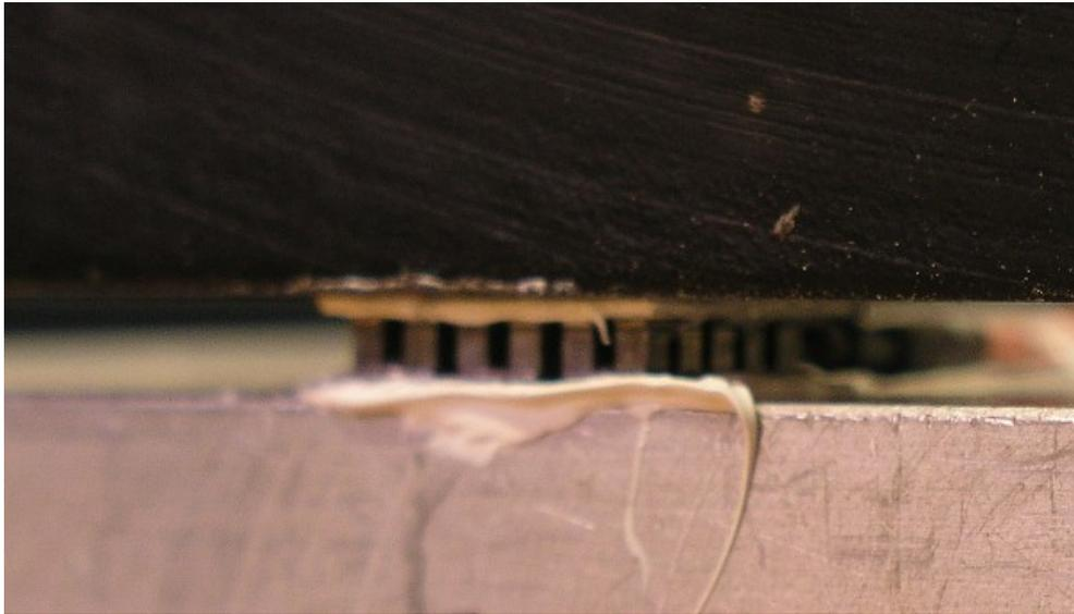
Abb.1: Peltierelement zwischen 2 Aluminiumblöcken
