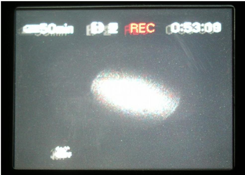
Abb. 3: Spot einer Laserdiode im nahen IR von einer Videokamera aufgenommen
