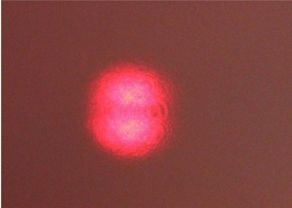
Abb. 8: Transversale Moden bei vorsichtiger Verkippung der Resonatorspiegel.
