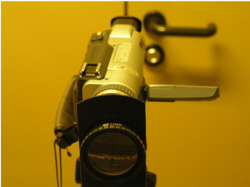
Abb. 9 und Abb. 10: Teleskopanordnung für 50-fache Vergrößerung
