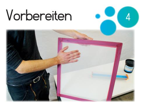
Mit dem Beschichten wird immer an der Außenseite des Siebs angefangen. Das ist die Seite, die später auf dem T-Shirt liegt.
