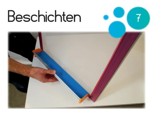
Jetzt wird solange gewartet, bis die Fotoemulsion überall bis an das Sieb geflossen ist.
