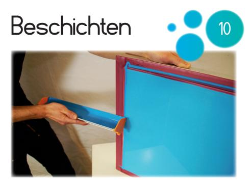
Die überschüssige Fotoemulsion wird wieder mit der Beschichtungsrinne eingesammelt. Dazu wird die Beschichtungsrinne waagerecht gehalten.
