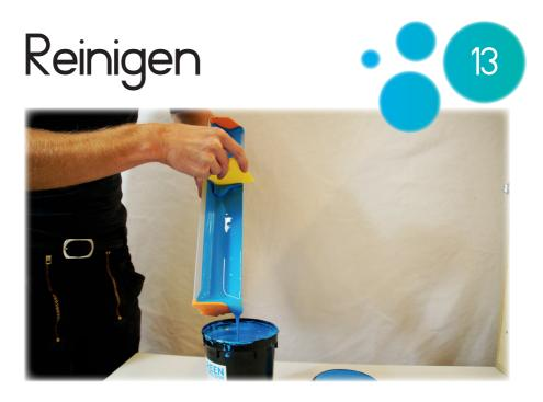
Die letzten Reste der Fotoemulsion werden mit dem Spachtel aus der Beschichtungsrinne entfernt.
