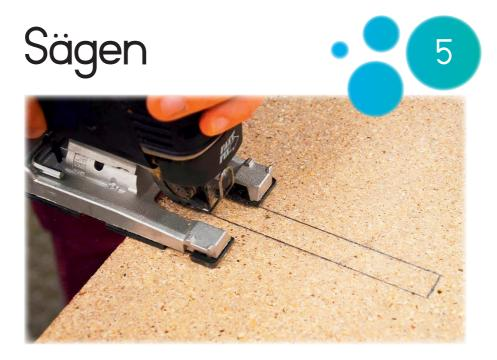
Ich säge das Werkstück auf beiden Seiten bis zur Linie ein.
