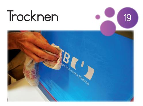
Das Sieb wird mit einem Baumwollhandtuch abgetupft. In den Motiven darf kein Wasser mehr sein. Zur Kontrolle wird das Sieb in das Licht gehalten.
