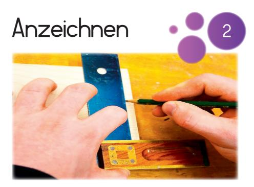
Mit Hilfe eines Anschlagwinkels wird bei 45cm eine gerade Linie angezeichnet.
