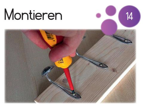
Im letzten Schritt werden die Löffel mit Hilfe der Linsenkopfschrauben auf den entsprechenden Markierungen auf dem Holzzuschnitt festgeschraubt.
