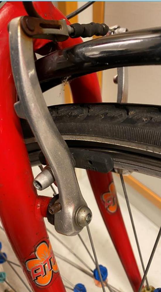
Fahrradreparatur – Felgenbremsbeläge – (V-Brake)
