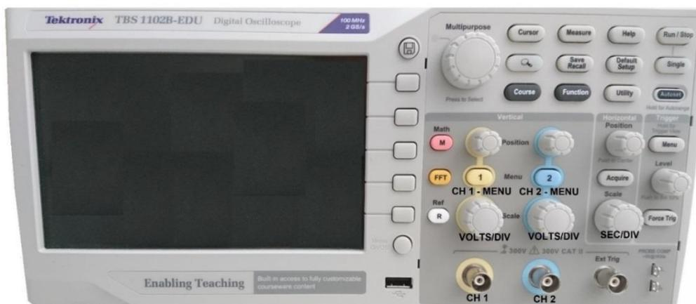
Abb.9: Frontansicht des Digital Oszilloskops TEKTRONIX TBS 1102B - EDU.
