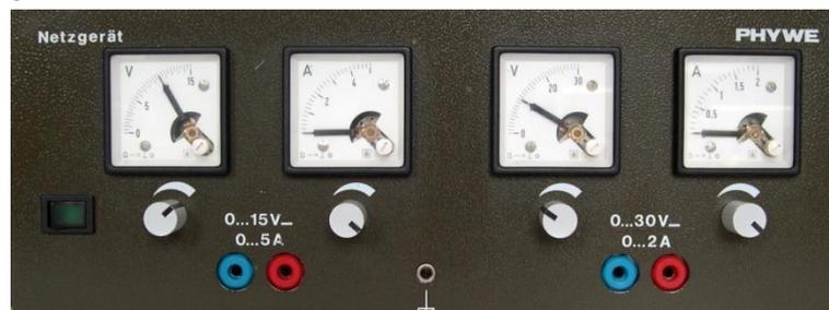
Netzgerät vom Typ PHYWE. An beiden Ausgängen (jeweils blaue und rote Buchse) ist eine Spannung von ca. 10 V eingestellt.
