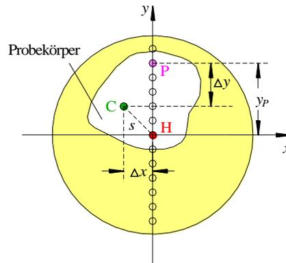
Abb. 2: Drehscheibe (gelb) mit Probekörper (weiß, Aufsicht). H ist die Drehachse, C die Schwerpunktschwerachse des Probekörpers<sup>4</sup> und P der Punkt der Fixierung des Probekörpers in der vertikalen Lochreihe auf der Drehscheibe.  $s$  ist der Abstand zwischen C und H.
