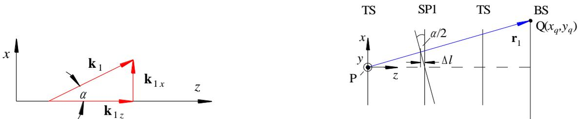
Abb. 5: Links: Wellenvektor  $\mathbf{k}_1$  bei Verkipfung der Ausbreitungsrichtung der Welle  $E_1$  um den Winkel  $\alpha$  gegenüber der  $z$ -Achse. Rechts: Ortsvektor  $\mathbf{r}_1$  bei Verkipfung des Spiegels SP1 um den Winkel  $\alpha/2$  um die  $y$ -Achse.
