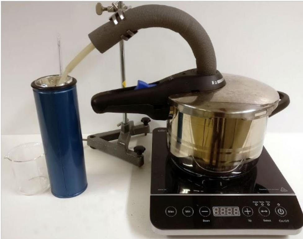
Abb. 7.6: Aufbau zur Verdampfungswärme von Wasser.
