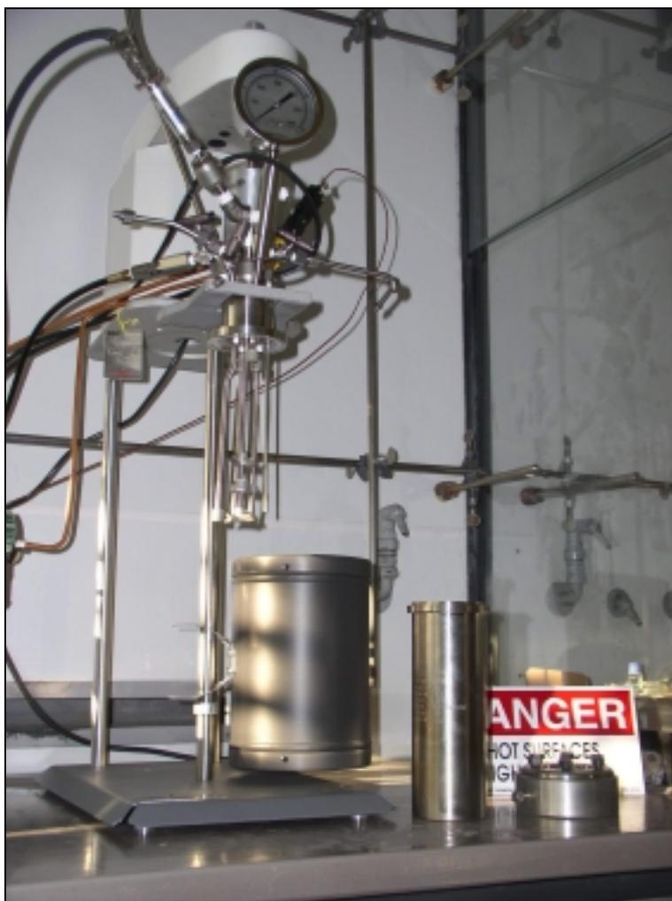
**Abbildung 3-1:** Autoklav für die Flüssigphasenhydroaminierung.
