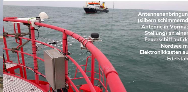
Antennenanbringung (silbern schimmernde Antenne in Vormast Stellung) an einem Feuerschiff auf der Nordsee mit Elektronikkasten aus Edelstahl.
