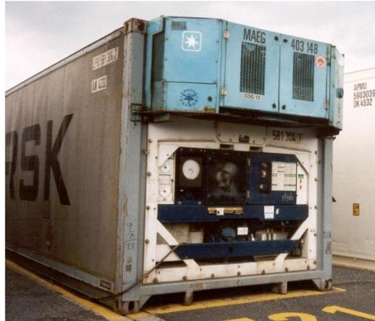
**Abbildung 10:** Integral-Kühlcontainer mit externem Kühlaggregat (Horn 2015)
