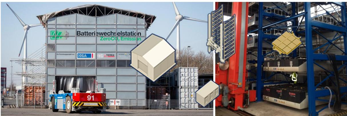
Die Wechselbatterien der autonom fahrenden Schwerlastfahrzeuge werden in einer zentralen Station mit Hochregallager geladen
