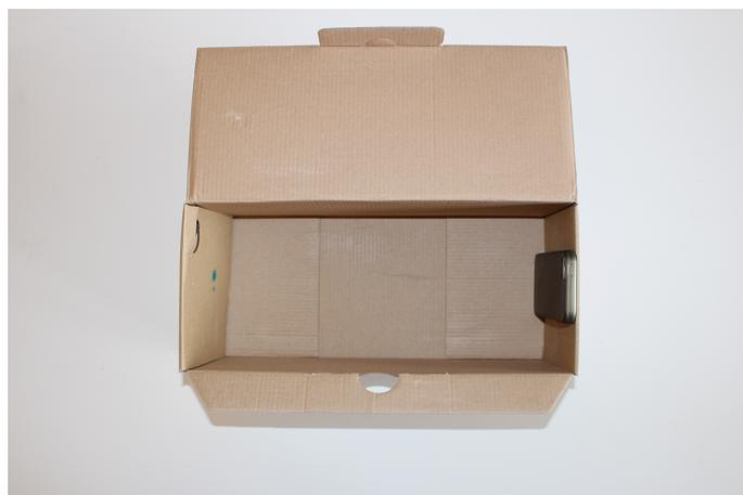
Abbildung 131: Prototyp Smartphone innerhalb des Teststandes, horizontale Ausrichtung
