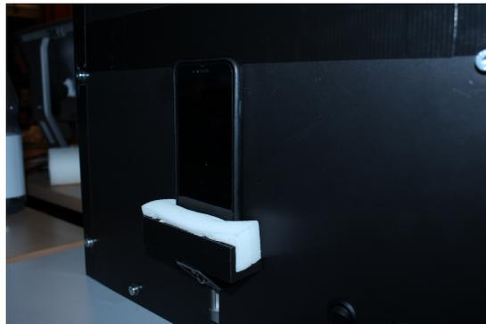
Abbildung 144: Stativ / Smartphonehalterung des Teststandes mit Smartphone
