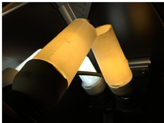
Abbildung 138: Lampenschirme aus Backpapier für die Erzeugung von diffusem Licht
