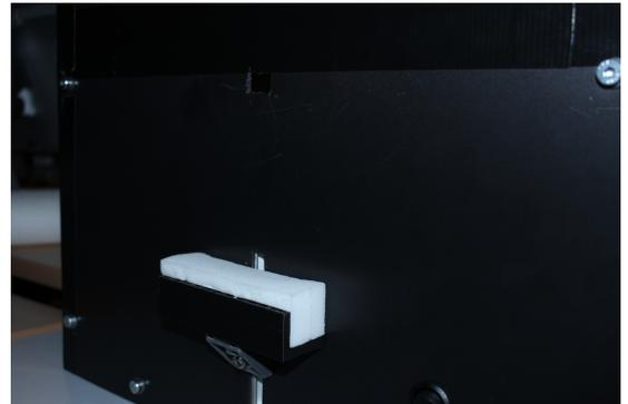
Abbildung 143: Stativ / Smartphonehalterung des Teststandes
