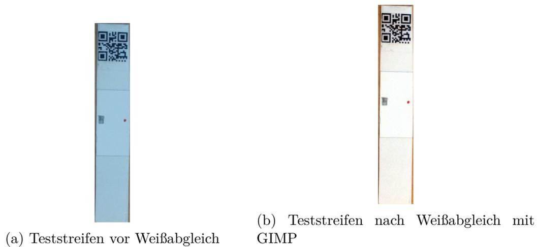
Abbildung 82: Teststreifen aufgenommen mit Smartphonekamera vor und nach dem manuellen Weißabgleich mit GIMP
