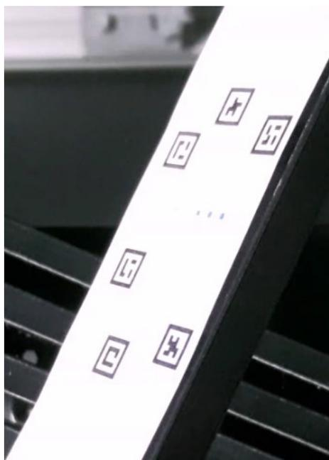
Abbildung 257: Teststreifenaufnahme auf der der Farbumschlag nicht mehr zu erkennen ist
