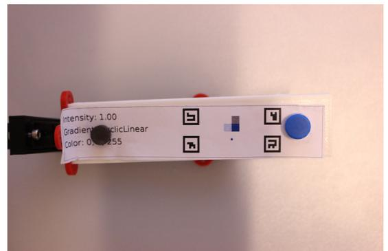
Abbildung 151: Neue Teststreifenhalterung mit eingesetzten Magneten
