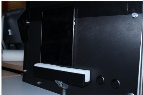
Abbildung 147: Stativ für Tablets mit einem vertikal positionierten iPad Mini 3
