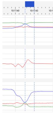
Abbildung 3.15.: Beispiel Hinsetzen (Reihenfolge der Daten Accelerometer, Gyroskop, Megnetometer)
