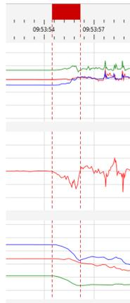
Abbildung 3.14.: Beispiel Aufstehen (Reihenfolge der Daten Accelerometer, Gyroskop, Magnetometer)
