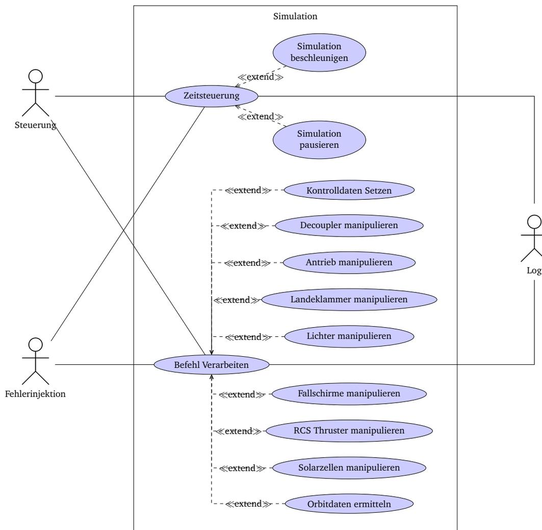
Abbildung 4.1.: Anwendungsfalldiagramm des Simulators
